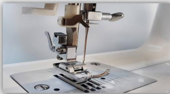
ساز و کار حرکتی شانه ای در چرخ خیاطی
