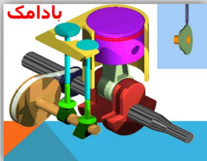
باز و بسته شدن سوپاپ های خودرو
