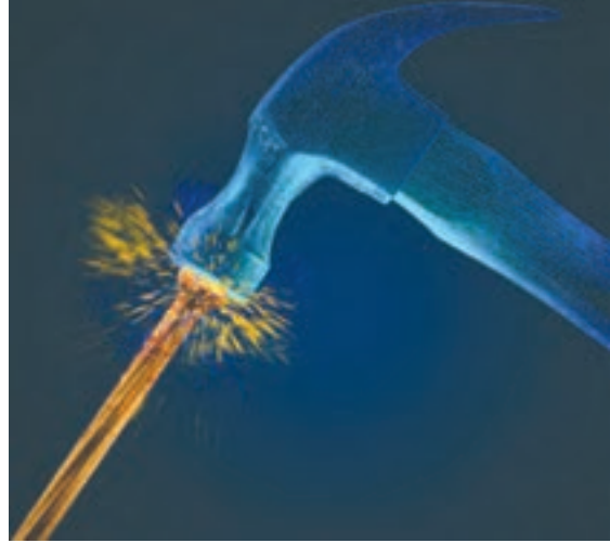
شکل ۱ - در برخورد چکش با میخ، چکش به میخ نیرو وارد می‌کند و میخ نیز به چکش.
