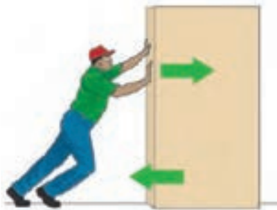
شکل ۲ - شخصی به جعبه ساکن نیرو وارد می‌کند ولی جعبه حرکت نمی‌کند؛ زیرا نیروی روبرو به جلو با نیروی اصطکاک رو به عقب هم‌اندازه‌اند.
