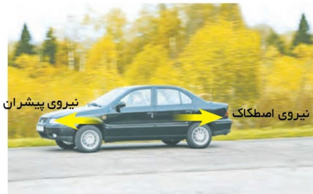
شکل ۳ - وقتی نیروهای وارد بر خودروی در حال حرکت متوازن باشند، خودرو با سرعت ثابت حرکت می کند.
