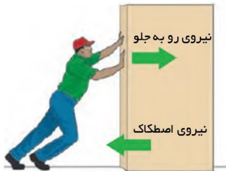
شکل ۲ - شخص به جعبه ساکن نیرو وارد می کند ولی جعبه حرکت نمی کند زیرا نیروی رو به جلو با نیروی اصطکاک رو به عقب هم اندازه اند.
